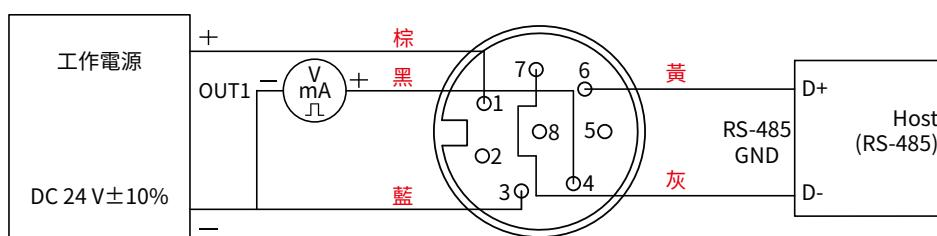
\*請確認產品與連接RS-485之儀器共地，避免接地電壓差造成損害。
